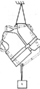
図4 垂直強度試験用型枠
