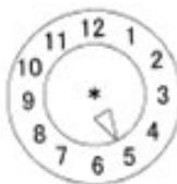
\* 製造年の最後の2つの数字はこの場所に表示して良い。その場合、時計円がUN設計型式マークに隣接して表示されている場合、マーク内のUN設計型式西暦年の表示は省略できる。ただし、時計円がUN設計型式マークに隣接して表示されていない場合は、マーク内と時計円内の西暦年の2桁は同一でなければならない。
